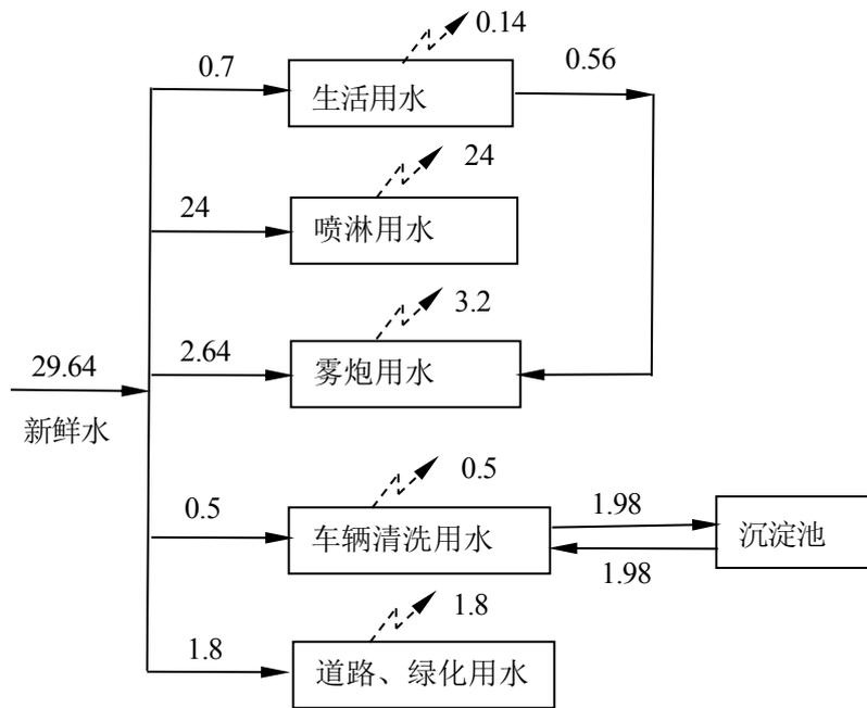
图 2-1 非采暖期水平衡图 (单位: m³/d)
