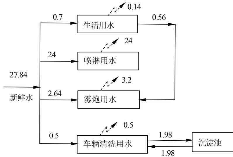
图 2-2 采暖期水平衡图 (单位: m³/d)
