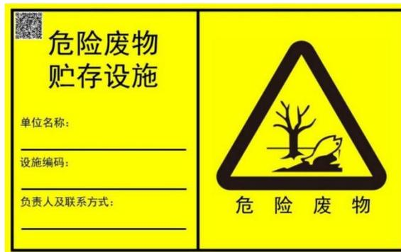
危险废物贮存标志牌示意图（危险废物设施标志背景颜色为黄色，RGB颜色值为（255,255,0）。字体和边框颜色为黑色，RGB颜色值为（0,0,0）；危险废物设施标志字体应采用黑体字，其中危险废物设施类型的字样应加粗放大并居中显示；三角形警告性图形与其他信息间宜加黑色分界线区分，分界线的宽度宜不小于3mm。）
