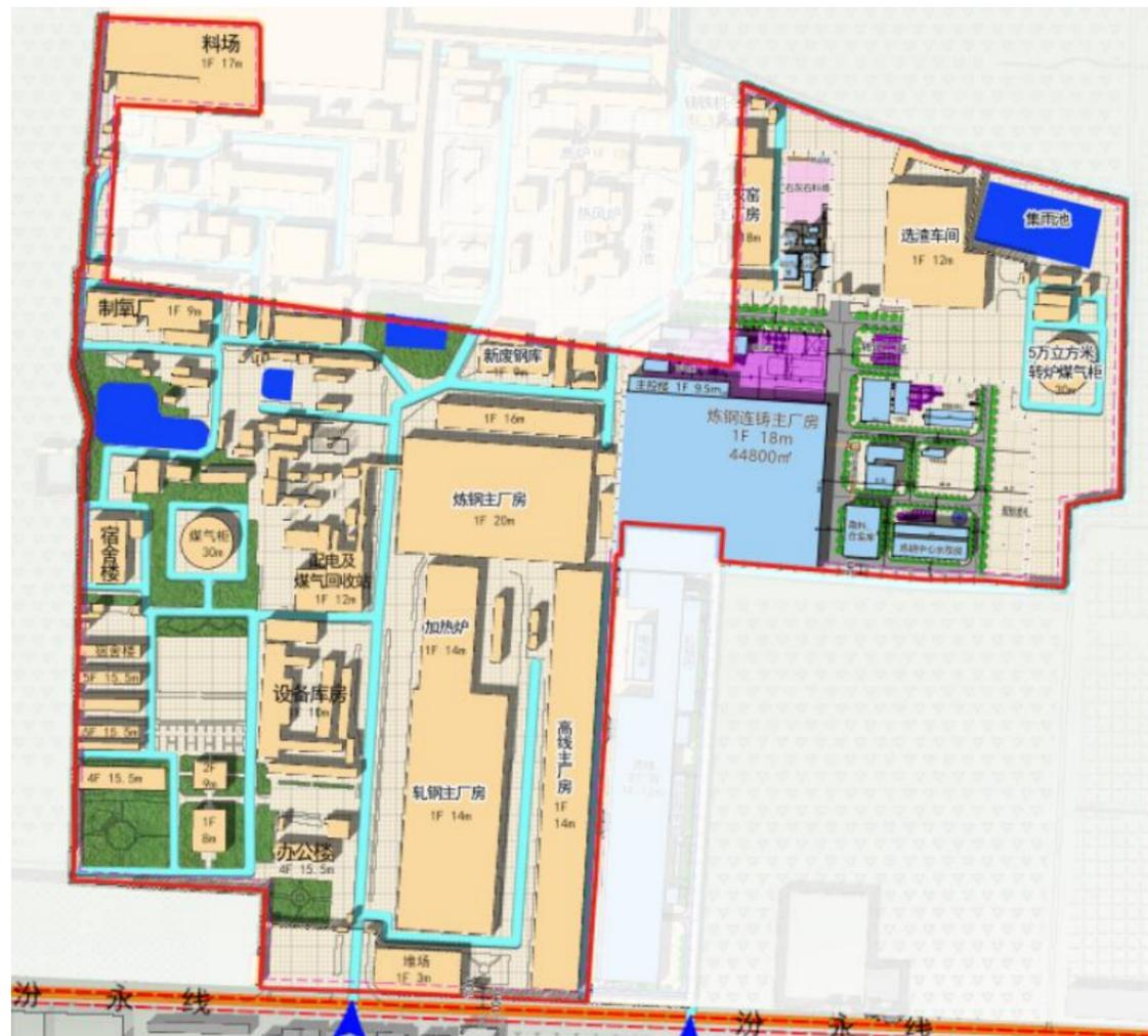
双膛窑项目位于炼钢转炉北侧，整体呈竖长方形地块，北侧为石灰石料厂、转运站和部分传送带；中部左侧为电气室，右侧为拉灰通道；南侧从左到右依次
